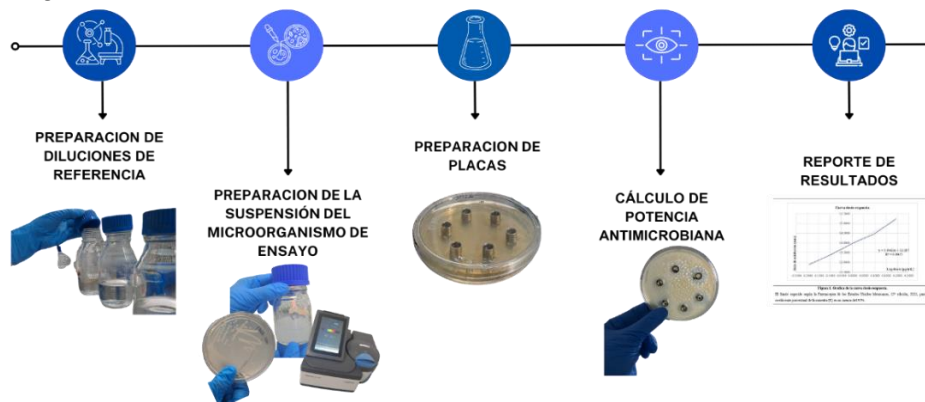
Figura 1. La metodología utilizada para el método Cilindro Placa (difusión en agar) tiene como referencia el MGA 0100, Valoración Microbiológica de Antibióticos de la Farmacopea de los Estados Unidos Mexicanos, 13a edición, (2021).
