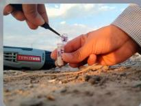
0.25 g de 3 muestras compuestas de suelo con 750 ul de buffer lisante/estabilizador Xpedition™ Zymo Research™
