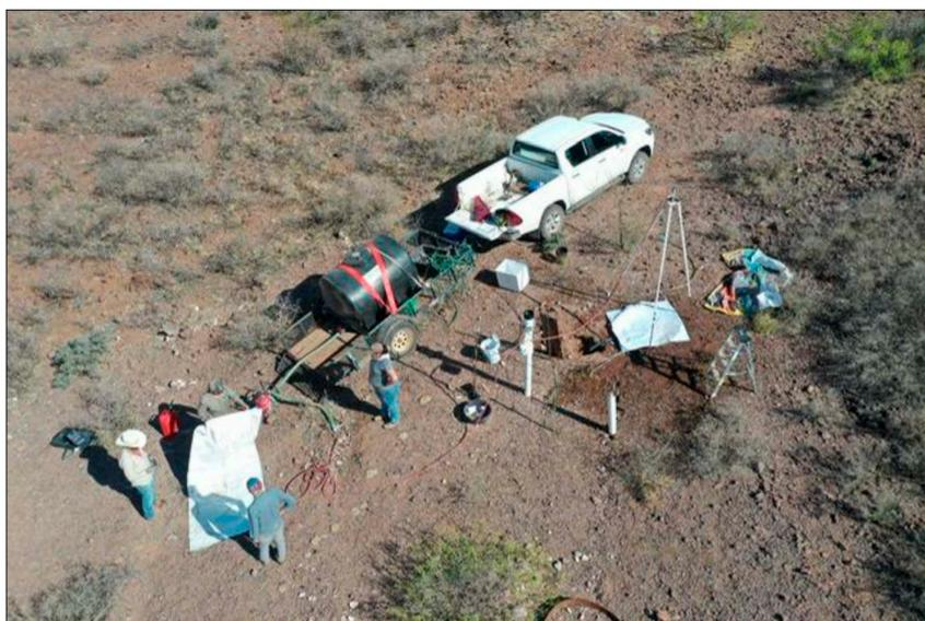
Figura 1. Imagen aérea de simulación de lluvia.
