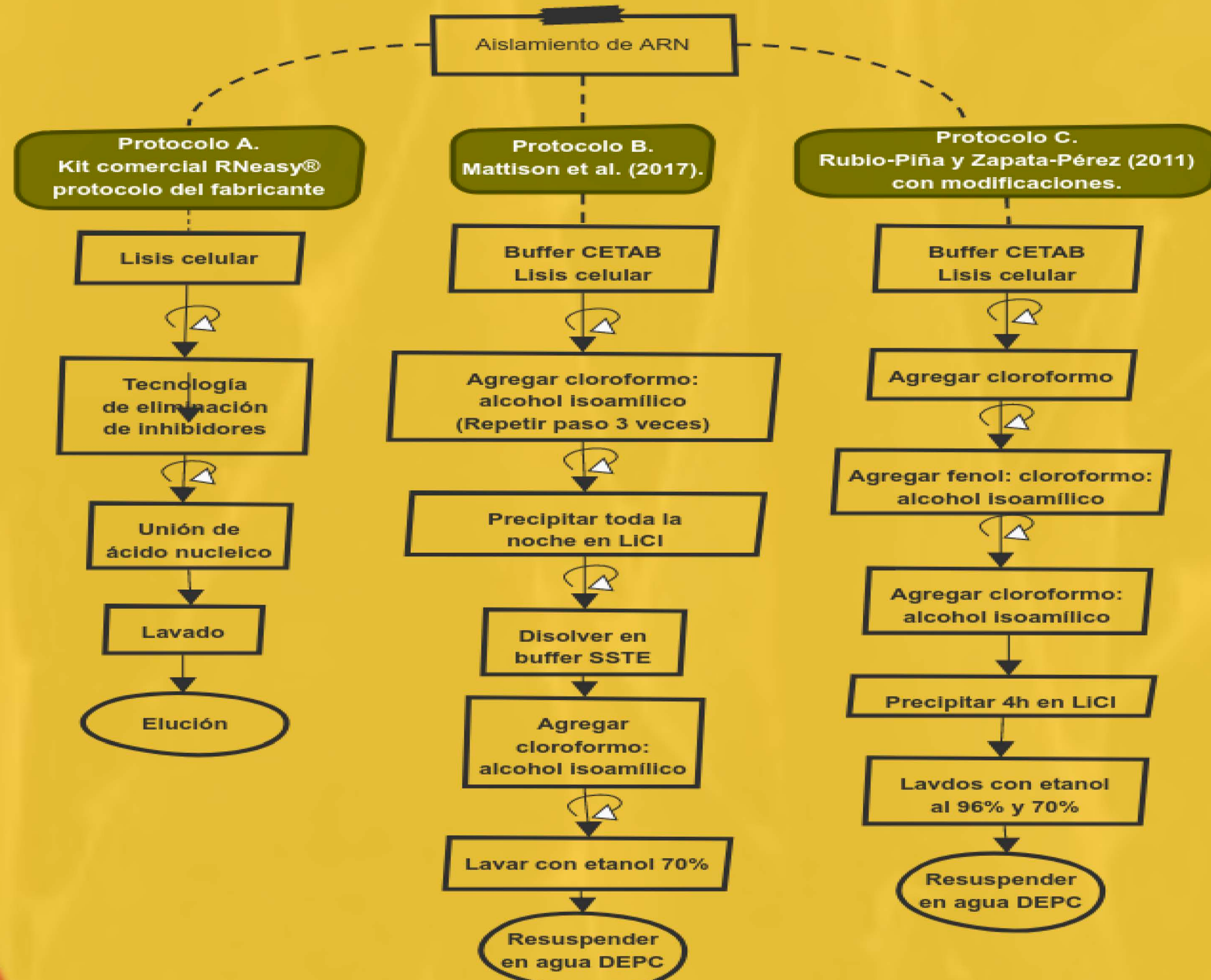
Figura 1. Procedimiento general de los protocolos de extracción de ARN. Previo a la extracción, los tejidos se molieron hasta obtener un polvo fino verde opaco usando un mortero y nitrógeno líquido. Para cada protocolo se evaluaron 4 muestras.
