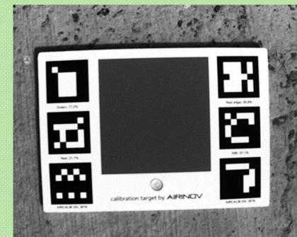
Figura 2. Target de calibración AIRNOV. Fotografía tomada en el momento de la calibración radiométrica de la cámara Sequoia Parrot.
