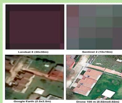
Figura 1. Comparación de la resolución de imágenes obtenidas de satélites, softwares y dron.
