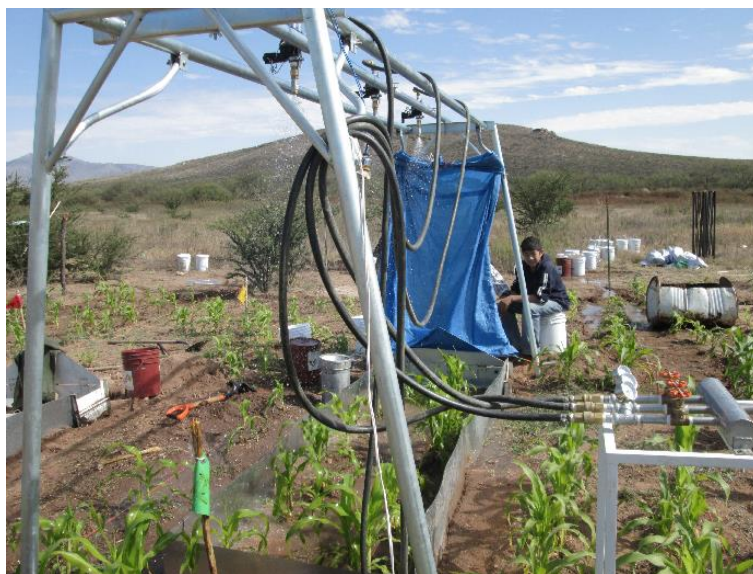
Figura 1. Detalle de simulador de lluvia y parcela de escurrimiento.
