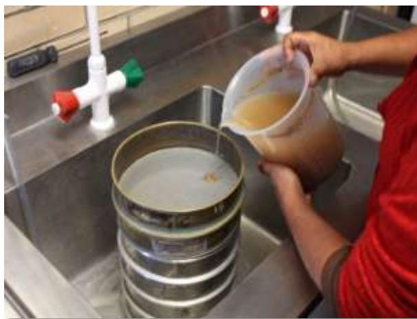
Figura 2. Suspensión a través de tamices.
