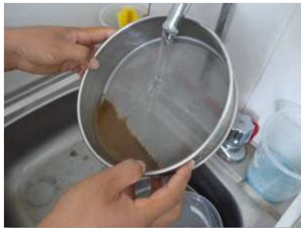
Figura 4. Obtención de la fracción de suelo.
